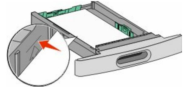
6 En su caso, ajuste las guías del papel para que toquen ligeramente los laterales de la pila y bloquee la guía de longitud para los tamaños de papel indicados en la bandeja.
